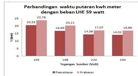
Gambar 4.2 Perbandingan putaran kwh meter prabayar dengan pascabayar menggunakan beban LHE
