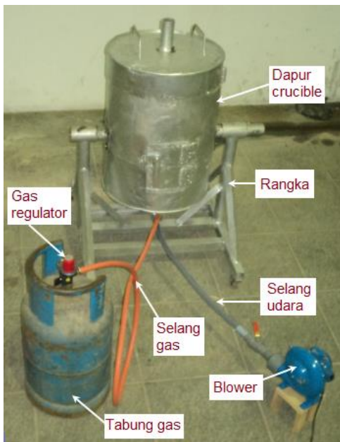
Gambar 2. Dapur crucible hasil rancangan
