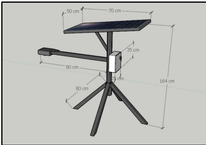
Gambar 3.1 Spesifikasi Ukuran Alat Deteksi Banjir Menggunakan Sensor HC-SR04 Berbasis Virtuino
