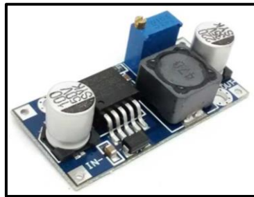
Gambar 2.20 Module Step Down LM2596 (Sumber: Ecadio)
