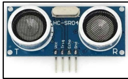
Gambar 2.7 Sensor Ultrasonic (Sumber: Nn.Digital)
