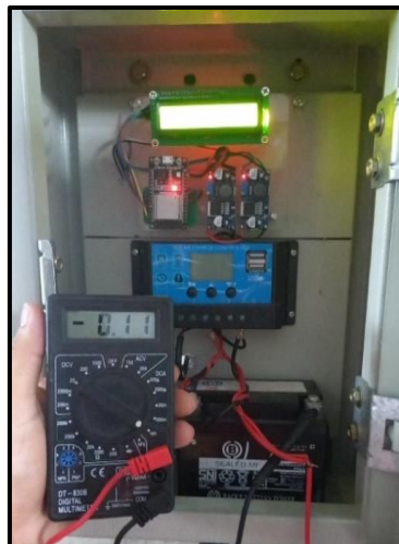
Gambar 4.6 Hasil Pengukuran Arus pada Alat
