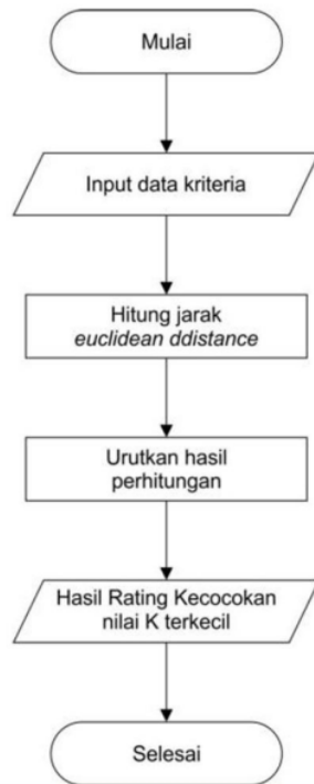
Gambar 1. Skema Algoritma K-NN pada Sistem Kelayakan Penerima Bantuan PKH
