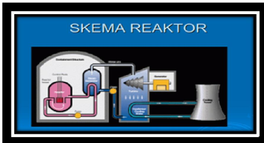
Gambar 3. 14. Skema reaktor Nuklir
