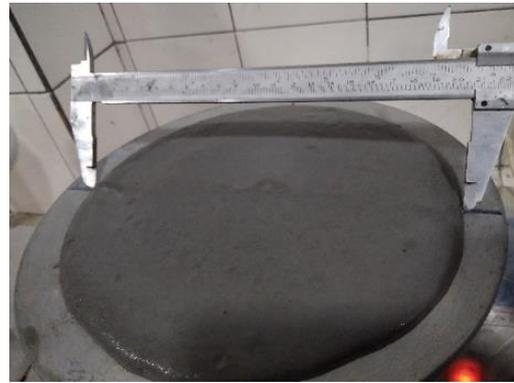
Gambar 3. Pengujian slump flow
