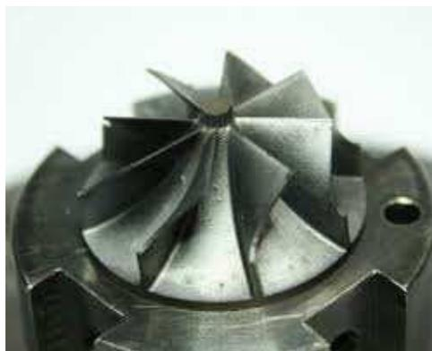
Gambar 9.2 Sudu yang dibuat dari silicon nitride ( $\text{Si}_3\text{N}_4$ )
