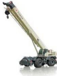
Crane terex 75 Ton
