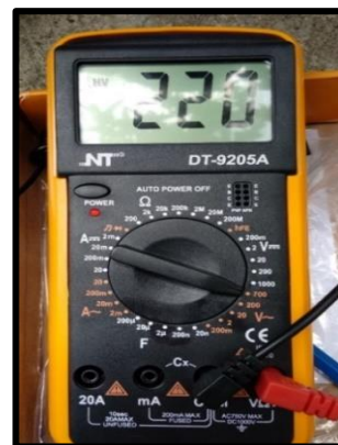
Gambar 5.22 Tegangan Keluaran pada Inverter
