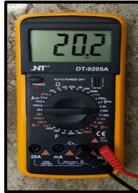
Gambar 5.18 Pengukuran Tegangan yang dihasilkan Panel Surya 100 wp
