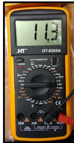
Gambar 5.26 Pengukuran Tegangan Keluaran Charging Baterai & Masukkan ke Inverter
