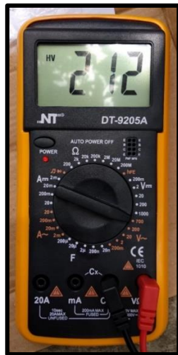
Gambar 5.27 Tegangan Keluaran pada Inverter
