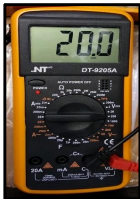
Gambar 5.23 Pengukuran Tegangan yang di Hasilkan Panel Surya dengan Adanya Beban
