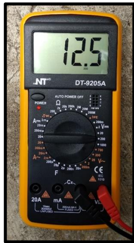
Gambar 5.25 Pengukuran Tegangan Masukan Charging Baterai
