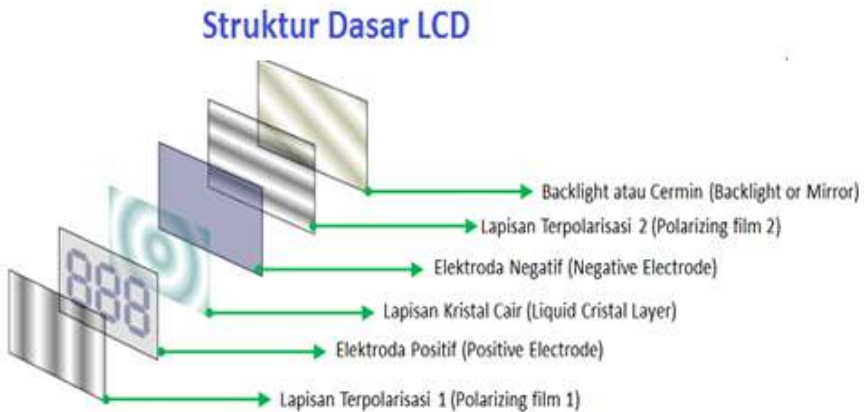
Gambar 9.3 Bagian Lapisan dari LCD
