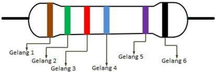
Gambar 2.16 Kode 6 warna gelang resistor
