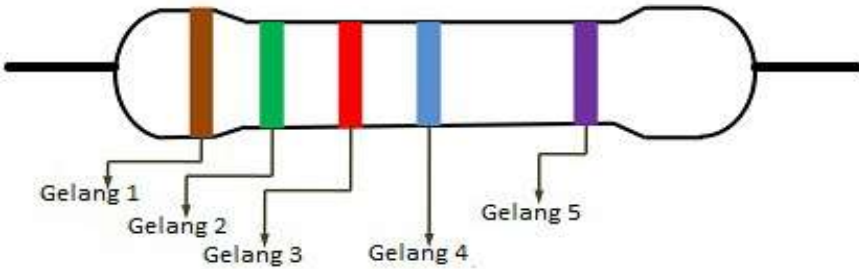
Gambar 2.15 Kode 5 warna gelang resistor
