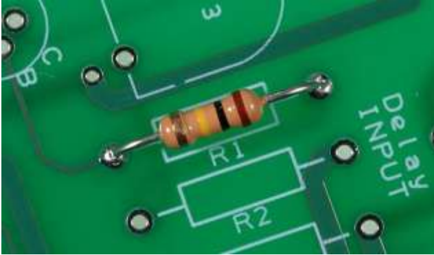
Gambar 2.13 Kode 4 warna pada resistor
