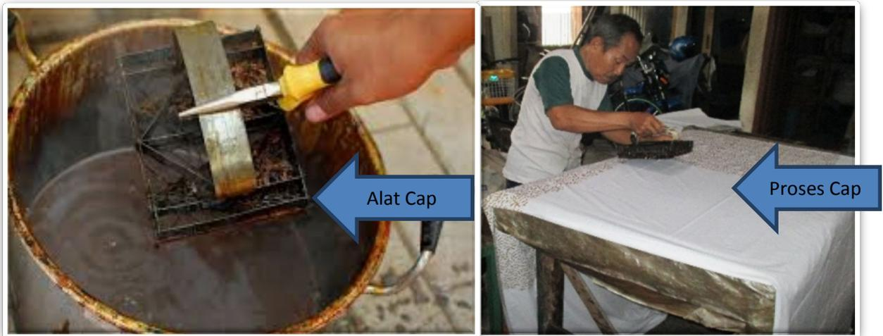
Gambar: 10. Pencelupan Alat Cap, dan Proses Ngecap.
