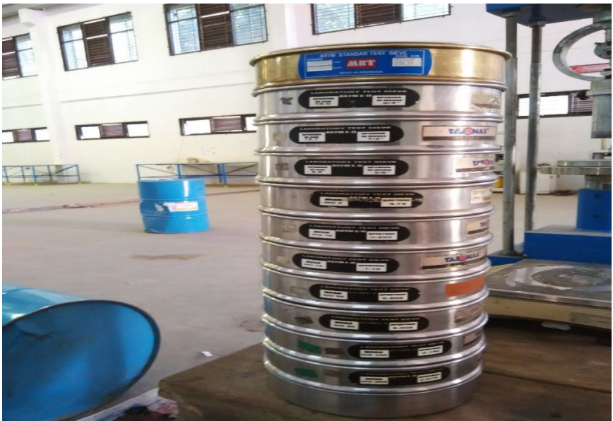
Gambar 4.15 Persiapan Saringan Agregat
