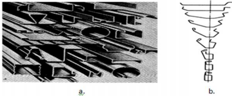
Gambar 3.4 a) Profil logam hasil pengerolan pelat b) Tahap pengerolan untuk pembentuk rangka penutup jendela.
