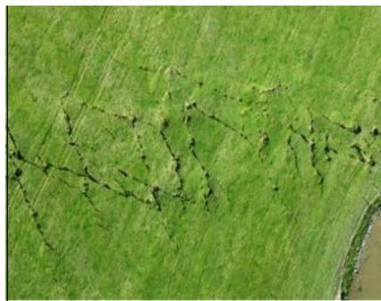
Gambar 3 Jalur rekahan gempa yang terlihat di perkebunan Canterbury New Zealand akibat gempa Darfield yang terjadi pada tanggal 4 Sep 2010
