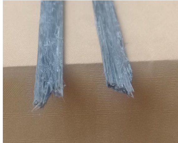
Gambar 3.4 Patahan Komposit AFRP V_f 40%
