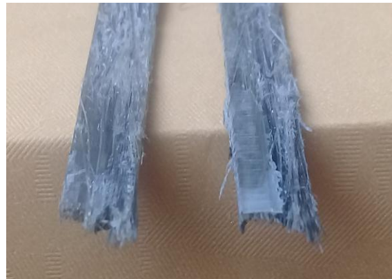
Gambar 3.3 Patahan Komposit AFRP V_f 30%
