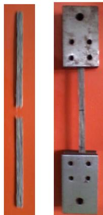
**Gambar 5.9.** *Setup* pengujian tarik dan hasil uji
