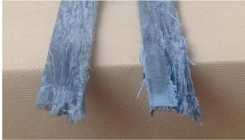
Gambar 5.13. Patahan Komposit AFRP  $V_f$  30%.
