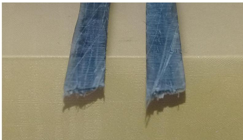
**Gambar 5.12. Patahan Komposit AFRP  $V_f$  20%.**
