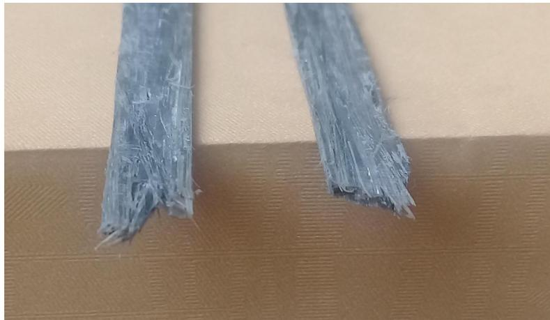
Gambar 5.14. Patahan Komposit AFRP  $V_f$  40%.
