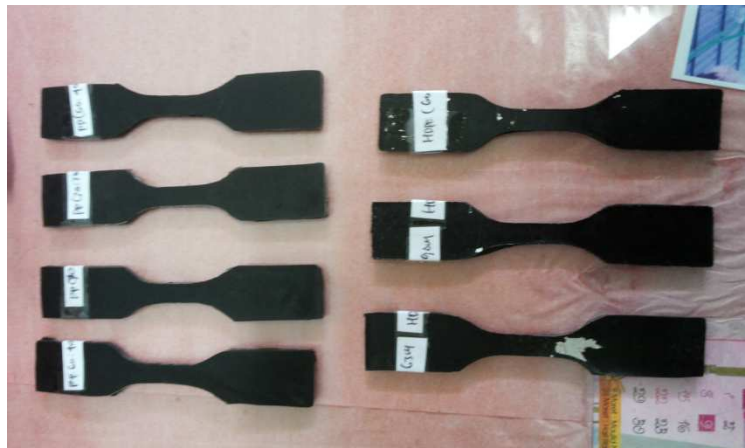
Gambar 5.2 Specimen komposit PP yang sudah dicetak
