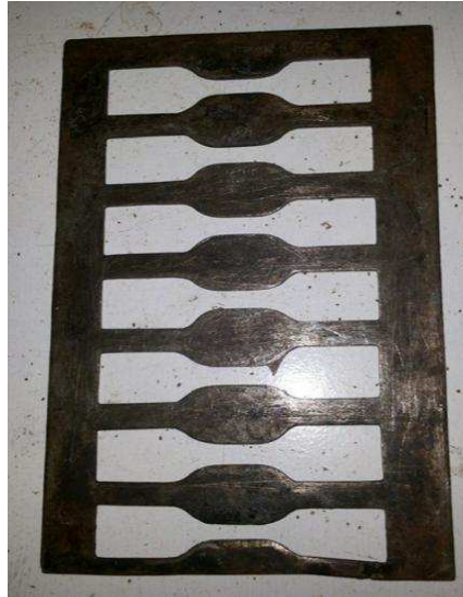
Gambar 5.1 Cetakan Specimen ASTM D-638 tipe IV
