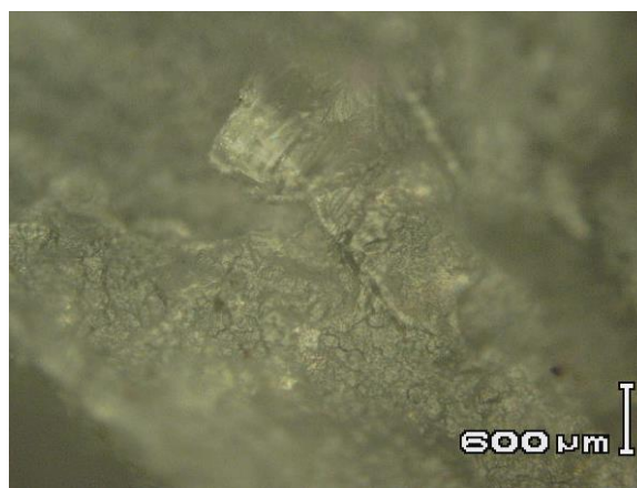
Gambar 3. Bentuk Permukaan Patah ( Fractografi ) dari komposit PP 1 Lapis serat dengan perbandingan 6% MA
