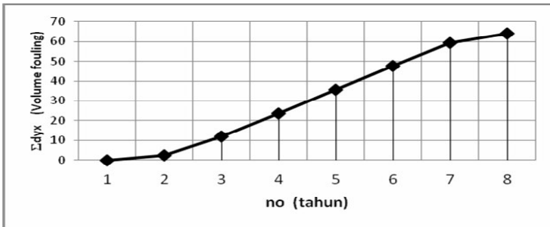
Gambar 4.3. Grafik hubungan laju penumpukkan fouling terhadap waktu. Sumber : HasilPerhitungan (2013)
