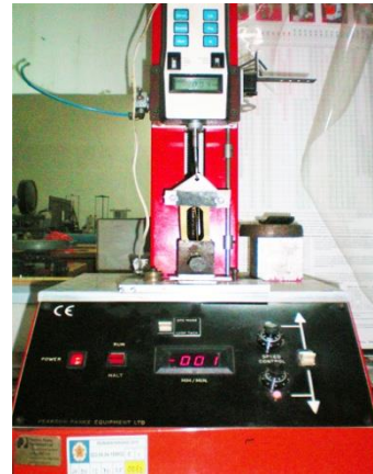
Gambar 1. Alat Uji Tarik Serat TENSOLAB
