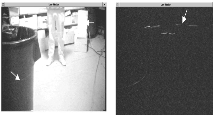
Gambar 5.2 Kiri, penglihatan kamera tanpa suppressi background, tanda panah menunjukkan penempatan laser yang dapat dilihat, dan kotak dibelakang diposisikan pada jarak 4m dari kamera. Kanan, penglihatan kamera dengan suppressi background, tanda panah menunjukkan jalur-jalur laser yang beririsan atau bersinggungan dengan kotak
