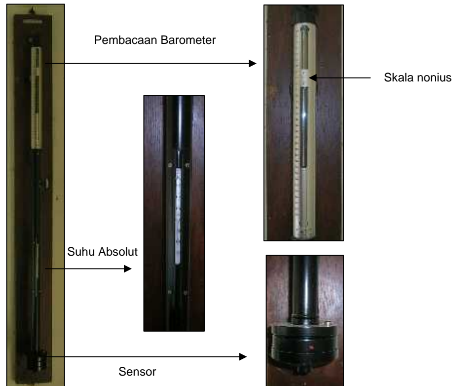
Gambar 6 Barometer Air raksa dan bagian-bagiannya
