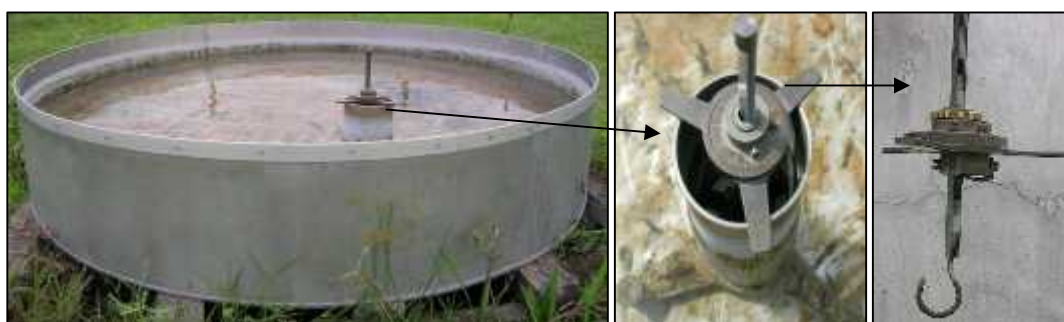
Gambar 14 Panci Kelas A dan Mikrometer Pancing
