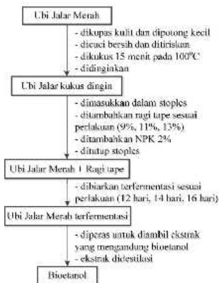
Gambar 1. Diagram Proses Produksi Bioetanol dari Ubi jalar Merah
